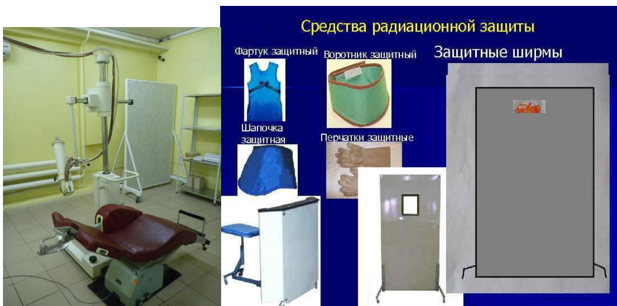
Рис.20 Подвижные защитные устройства (кожух рентгеновской трубки; защитная передвижная ширма).
