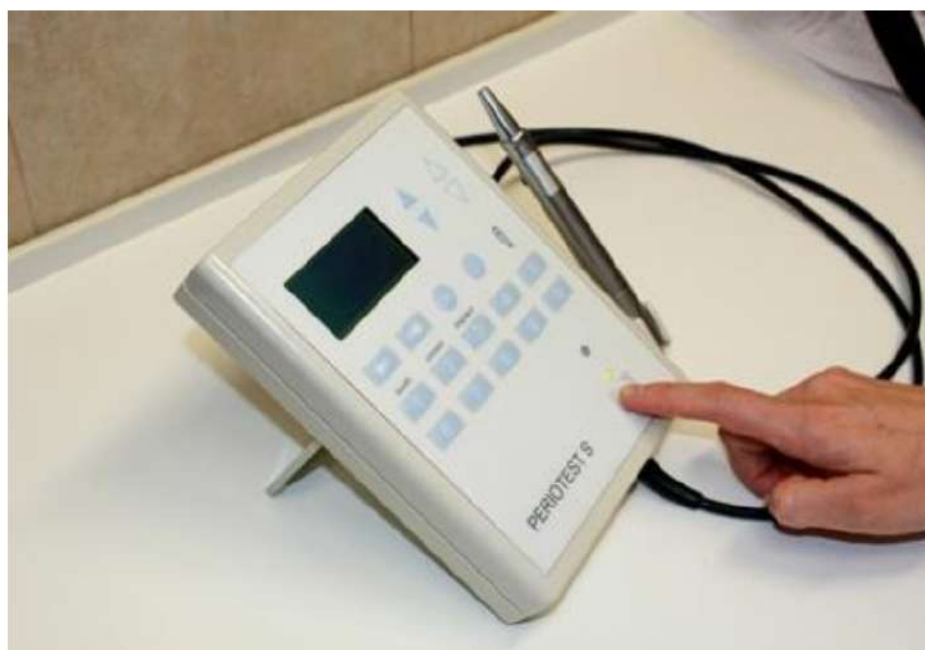
Рисунок 10 - Аппарат «Periotest S» для измерения степени остеоинтеграции дентальных имплантатов.
