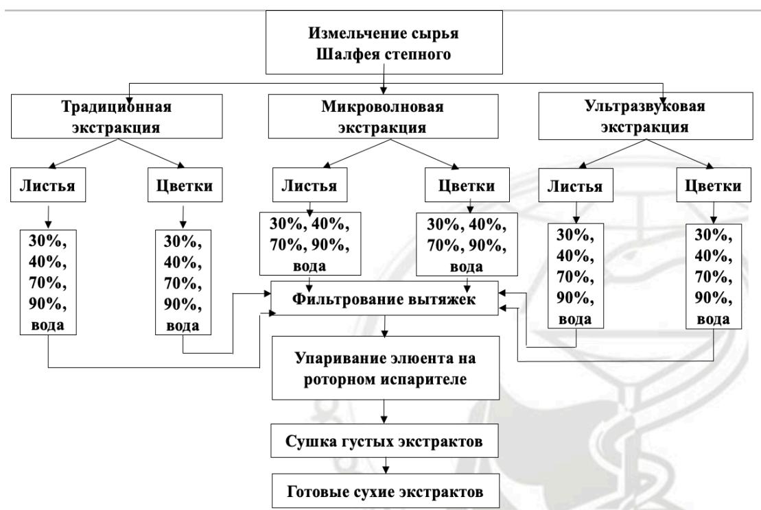
Рисунок 32 – Схематическое изображение получения сухих экстрактов шалфея степного традиционной, микроволновой и ультразвуковой экстракцией
