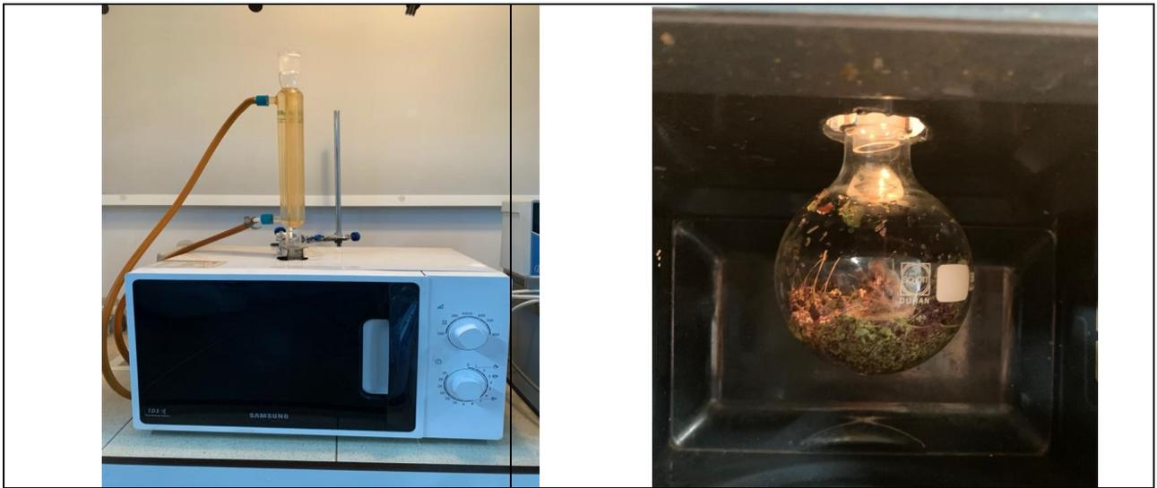
Рисунок 24 - а – микроволновая лабораторная печь, б – процесс микроволновой экстракции
