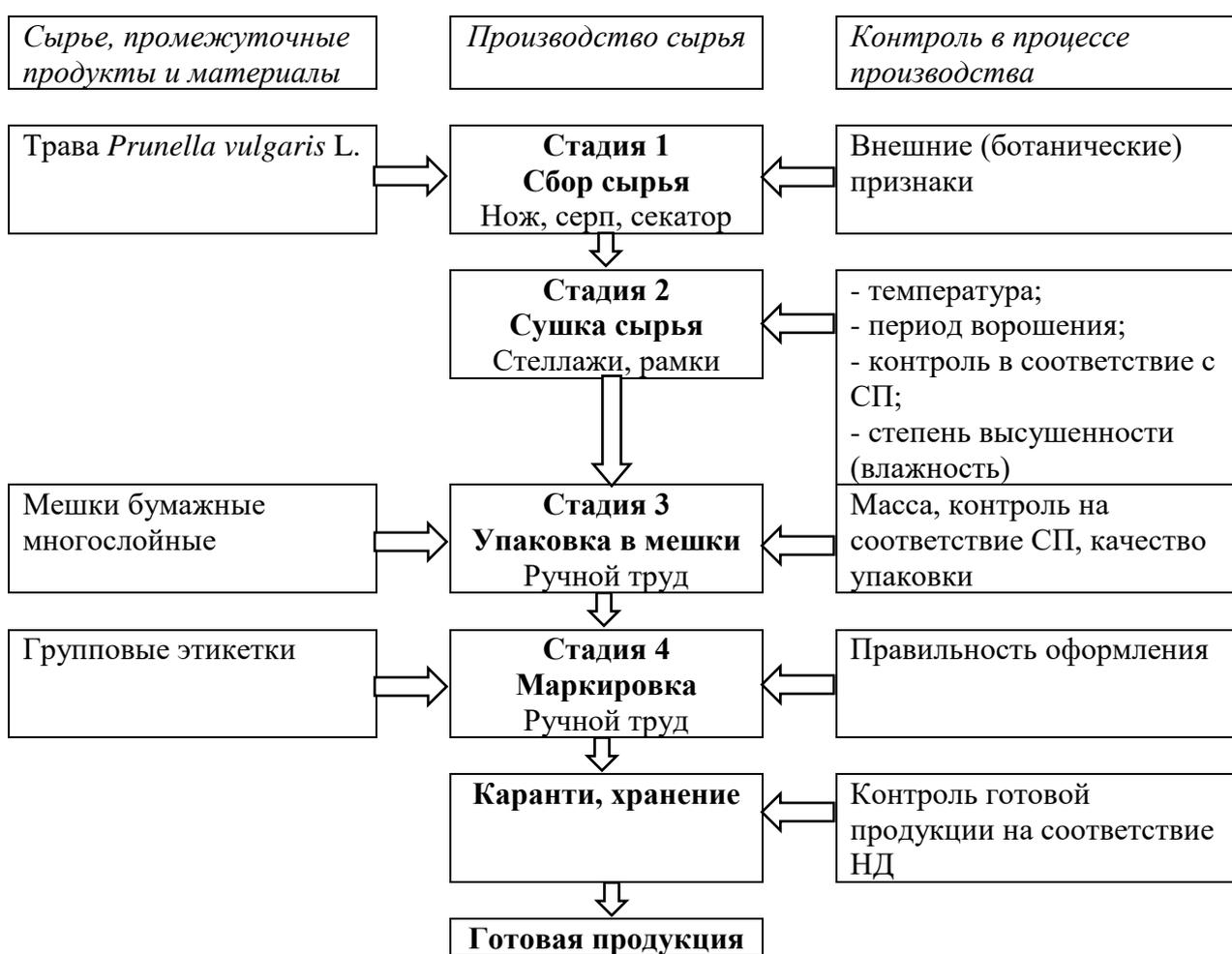
Рисунок 2 - Технологическая схема заготовки травы *Prunella vulgaris* L.
