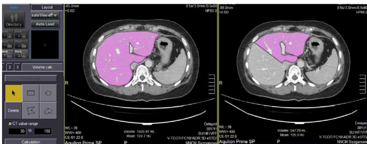
Рисунок 23 – Расчет объема печени оптимизированным методом. Порог максимальной плотности 160 HU
