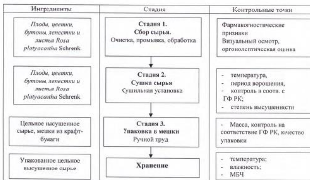
Рисунок 1 – Технологическая схема заготовки растительного сырья Rosa platyacantha Schrenk
