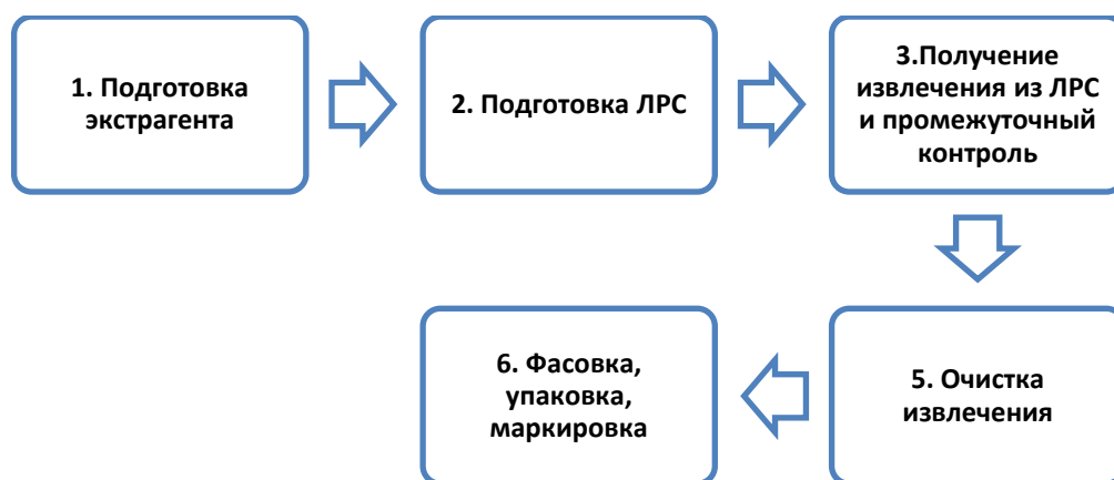
Рисунок 6 – Алгоритм проведения технологического процесса экстракции
