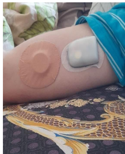
Рисунок 2 – Беспроводная инсулиновая помпа Medtrum и система непрерывного мониторинга глюкозы A7+ TouchCare® (Continuous Glucose Monitoring, CGM, НМГ) состоит из сенсора глюкозы и передатчика
