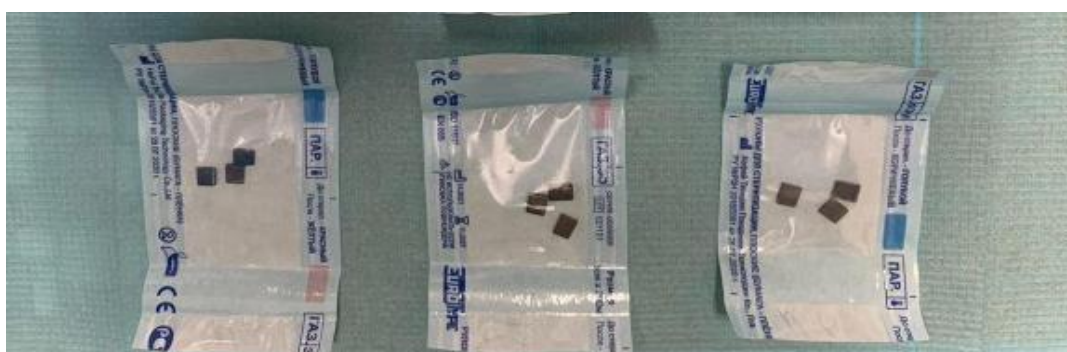
Рисунок 4 - титановые образцы в крафт-пакетах
